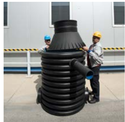
Поставување на конусот и шахтата е спремна за финално внатрешно заварување на сите споеви.
