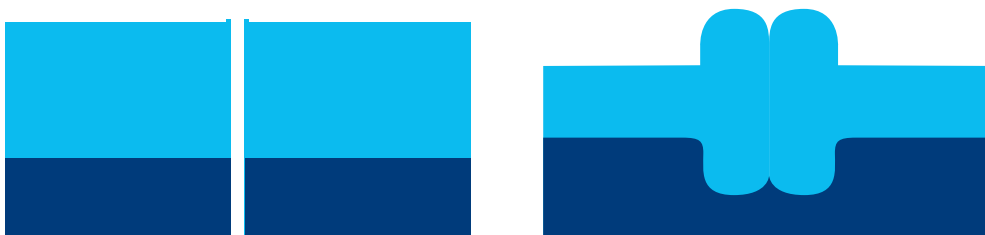
Порамнување и спојување на цевки каде што под притисок се појавуваат топчиња
